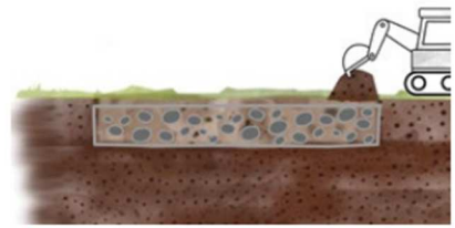
La tranchée drainante
